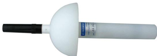
**Sonda di prova Ø 75 mm con estremità emisferica**
