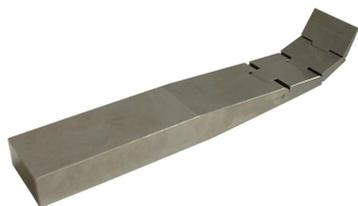
**Sonda di prova per parti in tensione non isolate**
